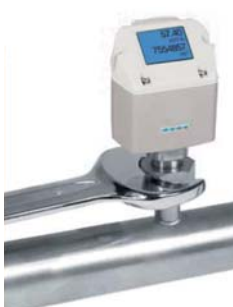
只须拆卸测量头即可进行标定
